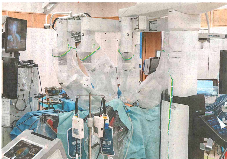
ダビンチ5を使った大腸がん手術。4本のロボットアームが患者の体内に挿入されている
